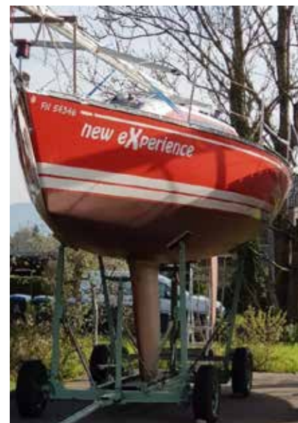
Es ist geschafft: Rumpf und Spiegel auf Hochglanz poliert und eingewachst, Unterwasserschiff geschliffen und frisch gestrichen
